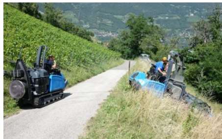
Links: der alte Mähdrescher mit Hangausgleich Rechts: die Erntemaschine wird mit einer Seilwinde gesichert; © Uni Bozen
