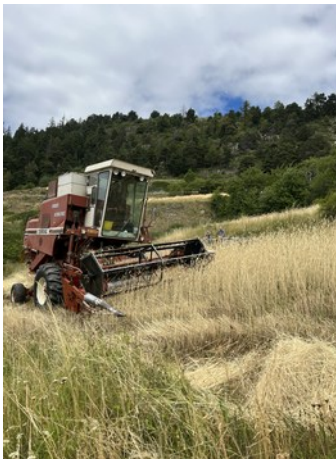
Links: der alte Mähdrescher mit Hangausgleich Rechts: die Erntemaschine wird mit einer Seilwinde gesichert; © Uni Bozen
