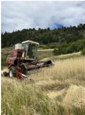
À gauche : l'ancienne moissonneuse-batteuse avec correcteur de dévers. À droite : la moissonneuse est sécurisée par un treuil ; © Université de Bolzano
