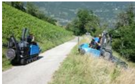
À gauche : l'ancienne moissonneuse-batteuse avec correcteur de dévers. À droite : la moissonneuse est sécurisée par un treuil ; © Université de Bolzano
