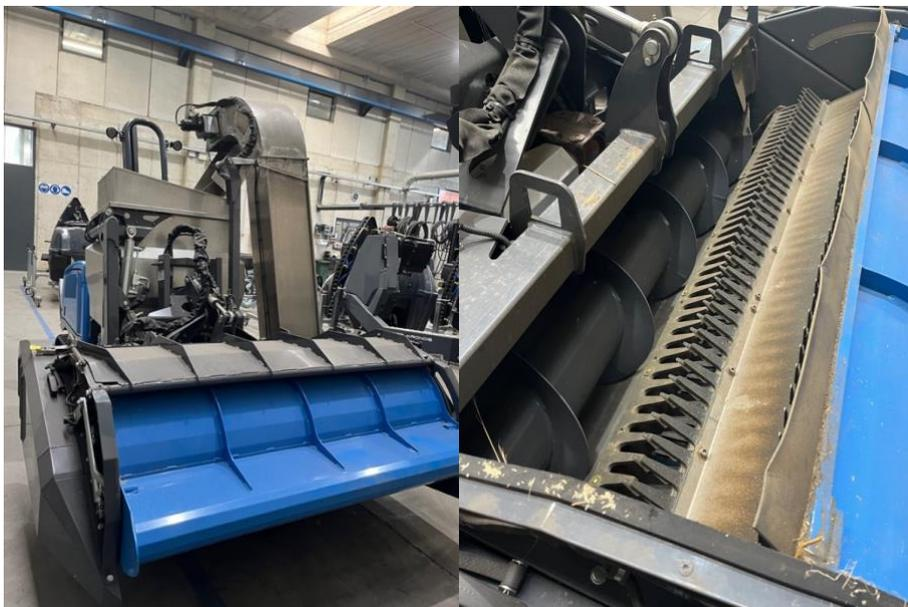
Abbildung 14 links: Prototyp des Head Stripper, rechts: Details vom Head Stripper
