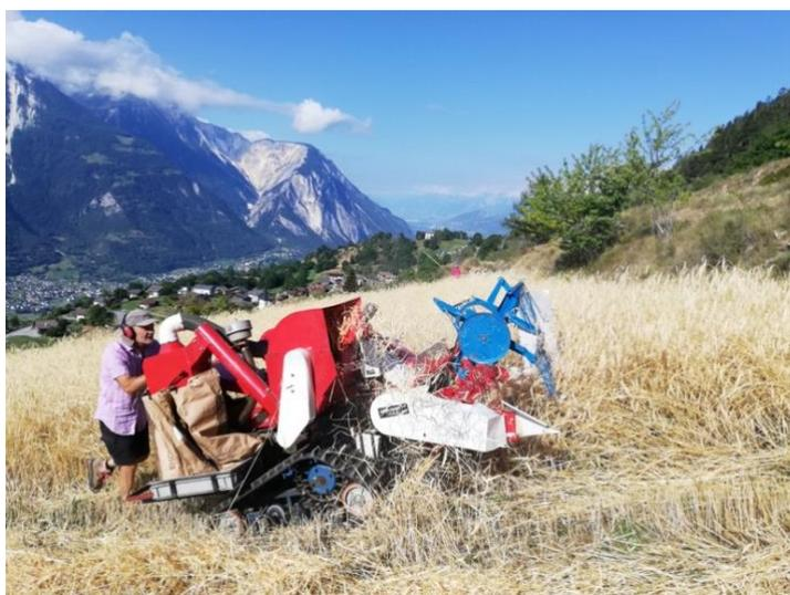
Abbildung 2 Combine Harvester 4L-0.8 im Einsatz bei der Roggenernte im Sommer 2022 in Erschmatt
