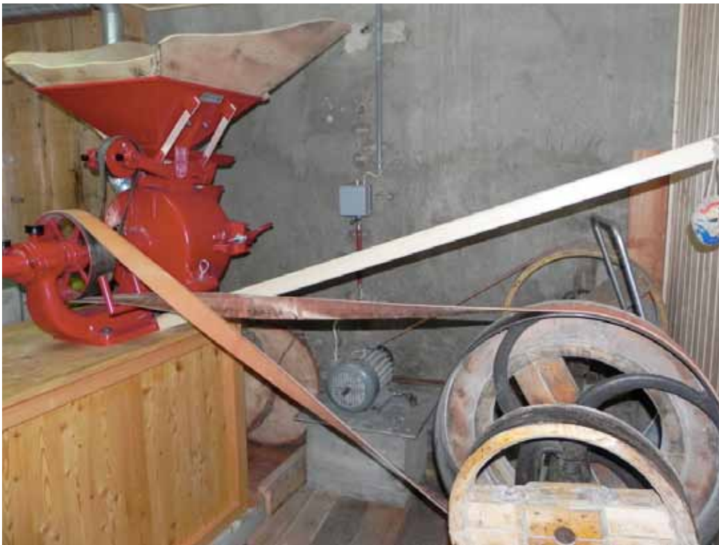
Im Hintergrund der Elektromotor. Am rechten Rad des Bildes die Antriebswelle. Auf dieser Welle ganz hinten an der Wand war früher das Wasserrad.
