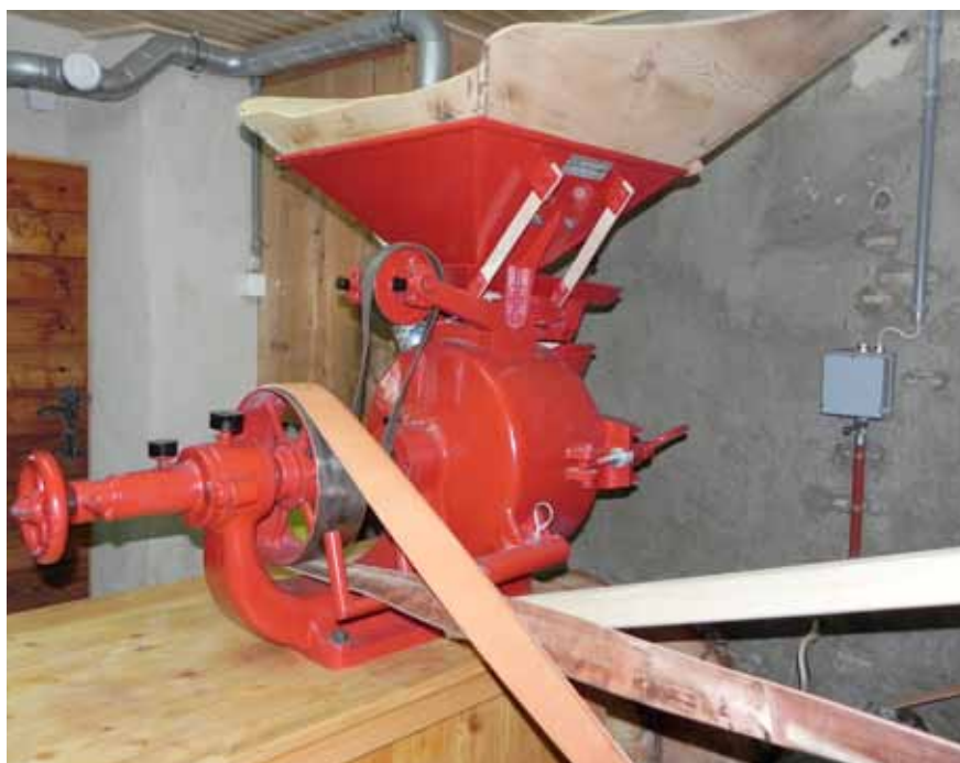
Erschmattener Mühle. Das kleine Handrad links im Bild dient dem Verstellen des Abstandes zwischen den beiden Mahlsteinen. Damit wird der Feinheitsgrad des Mehles reguliert.
